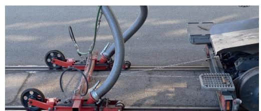
Nettoyage de tunnels/nettoyage humide de voûtes de tunnels, d'accotements ainsi que de voies de circulation (moteur peu polluant Euroclasse 5 à filtre à particules de suie)
